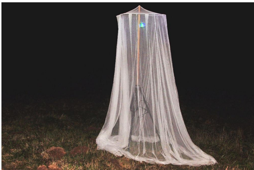
„Leuchtturm“ aus Stativ, Besenstiel, Mosquito-Netz, UV-Leuchte und Powerbank; 28.10.2022
